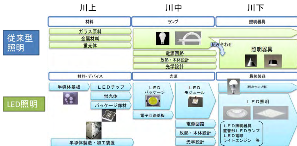
図 69 従来型照明とLED型照明の構造の差異
