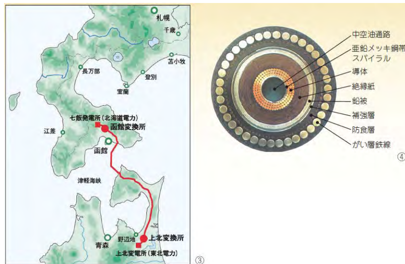
図 100 日本・日立の直流送電実績 出典：北海道・本州間電力連系設備 204
