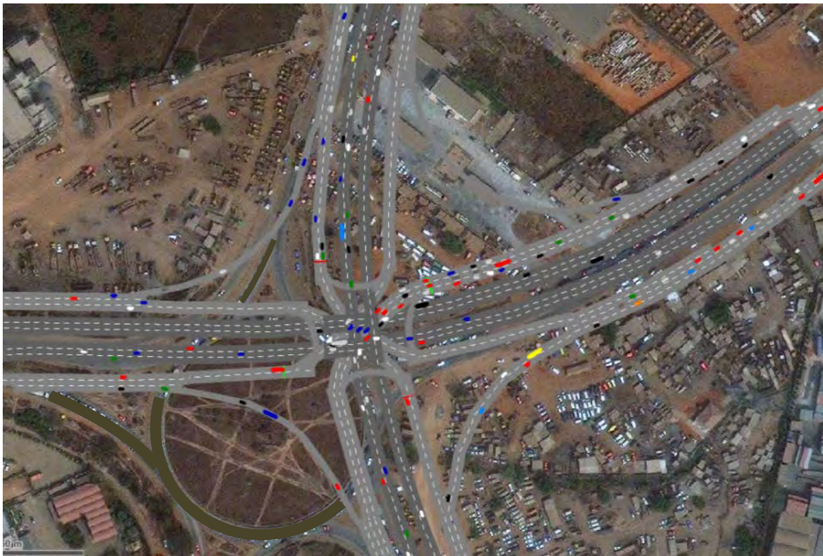
図 3-2-3.2 三層平面交差点型改良（集約ダイヤモンド型）
