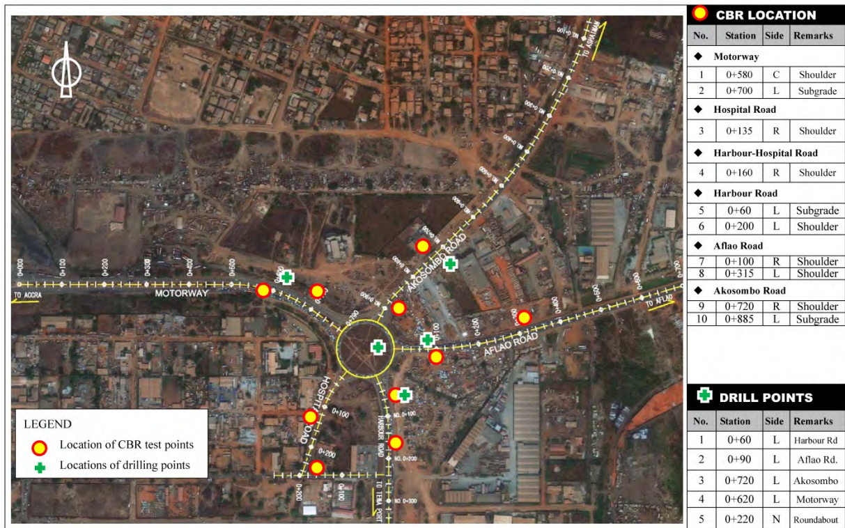
図 2-2-2.5 ボーリング調査及び CBR 試験位置
