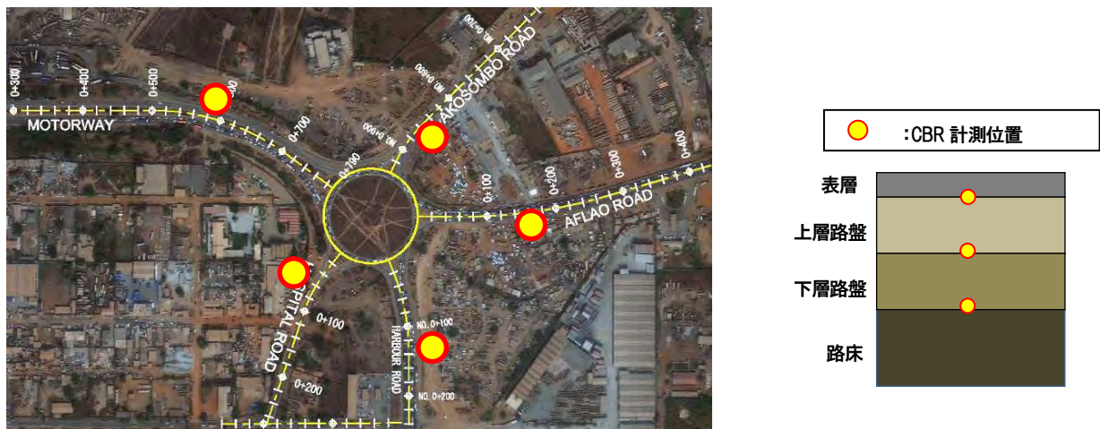
図 3-2-3. 28 舗装調査及び簡易 CBR 試験位置
