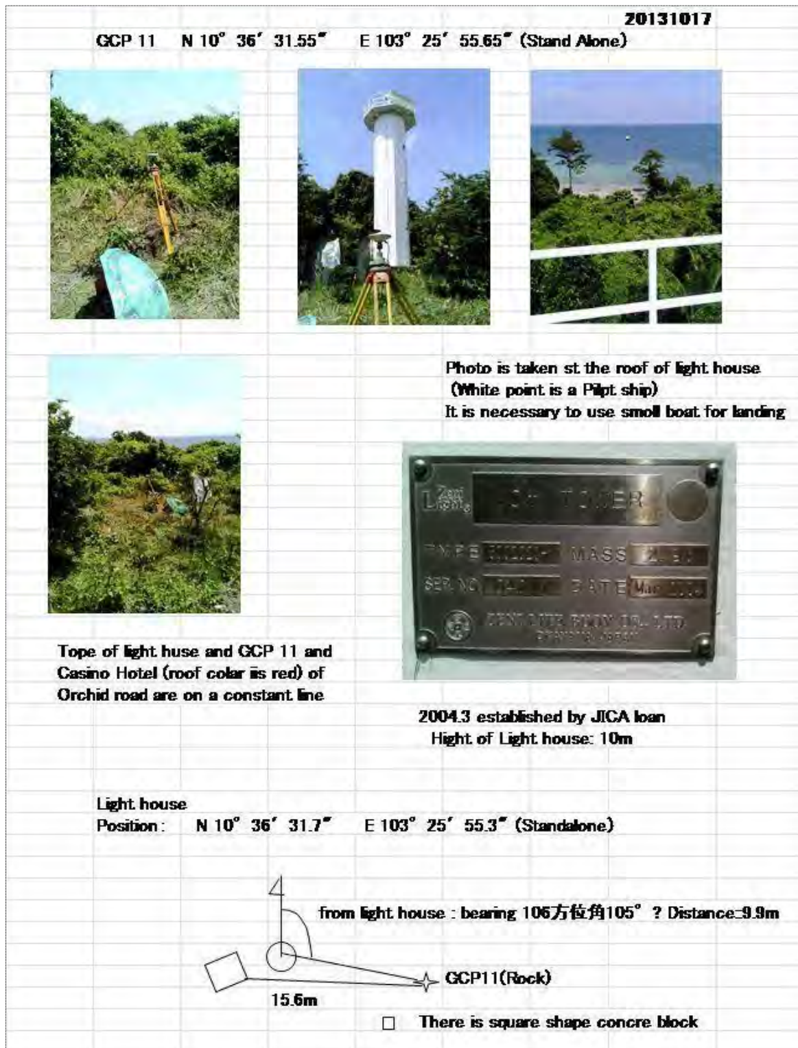
図 3 - 1 GCP11 の GNSS 基準点測量 中央右の写真は、SHV 港の JICA 開発計画時に設立された灯台の銘盤
