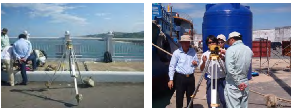
写真 3-7 GNSS 測量と水準測量の様子（調査団員から機器取り扱いの説明）
