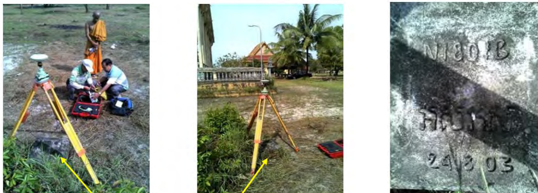
写真 2-1 国家 GPS 点(1801B)での GNSS 観測状況 (右の写真が標石)
