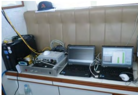
左から UPS, GNSS 受信機(黄色), SIM と Junction Box, SONIC 送受信信号制御 PC, HYPACK 用 PC
