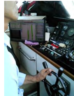
操船用誘導モニター
