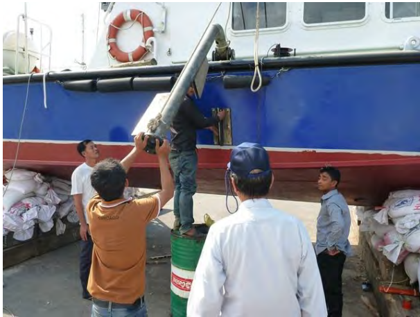
マルチビーム測深機送受波器設置部の取付け
