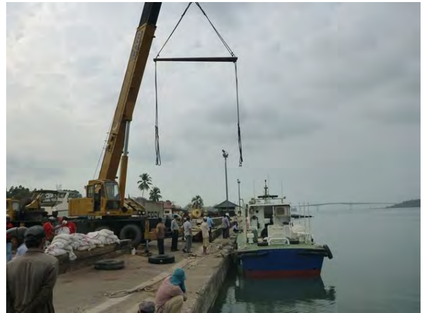
取付工事終了後の測量船の進水
