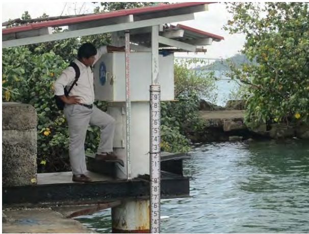
シハヌークビル港基準点 (PAS B. M) から験潮所までの水準測量
