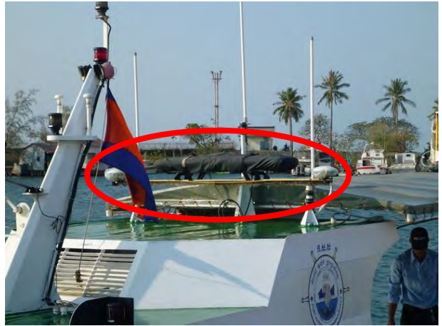
GNSS アンテナの取付け
