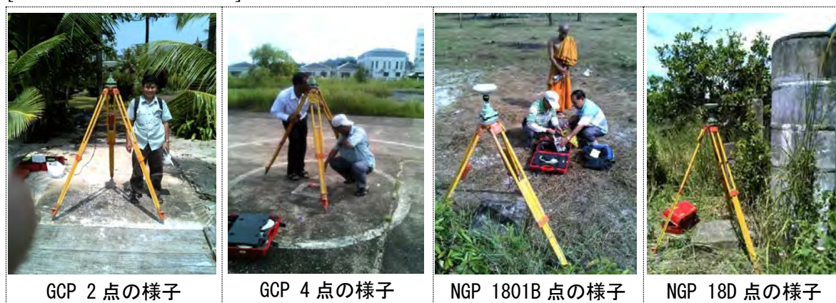
写真3-2 GNSSによる基準点観測
