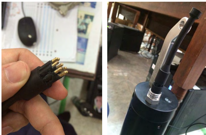
写真 3-20 水中音速度計のプラグとコネクタ一部
