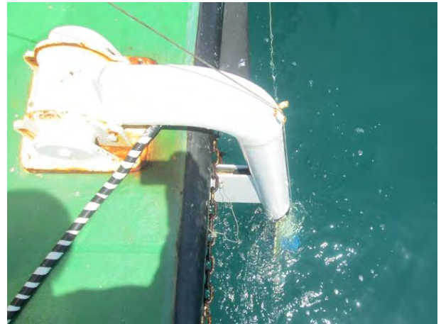
測深中のマルチビーム測深機送受波器
