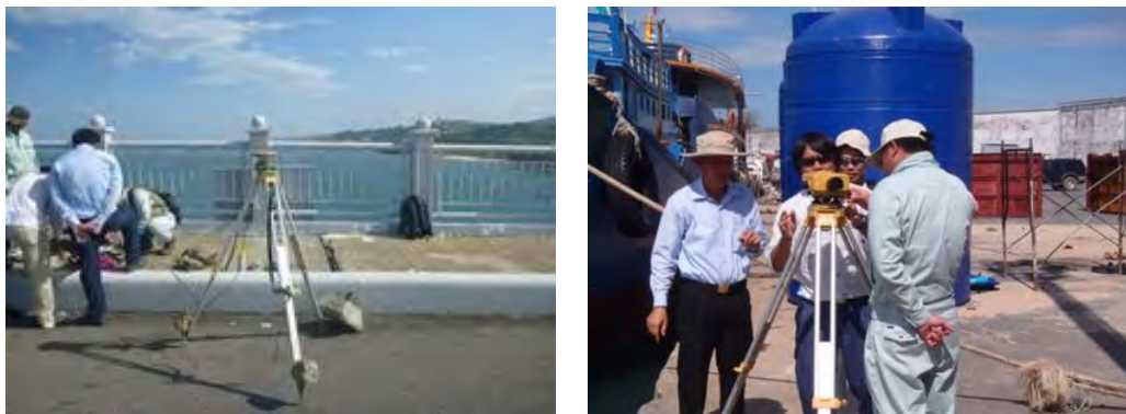
写真 3-7 GNSS 測量と水準測量の様子（調査団員から機器取り扱いの説明）
