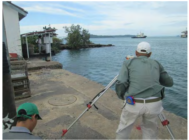
シハヌークビル港基準点 (PAS B. M) から験潮所までの水準測量
