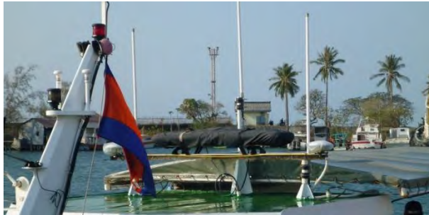
船橋上の二つの Trimble D-GNSS アンテナ
