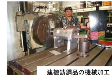
建機鑄鋼品の機械加工
