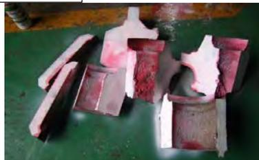
切断見本による内部欠陥保証
