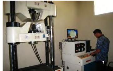
引張試験による機械的性質の保証
