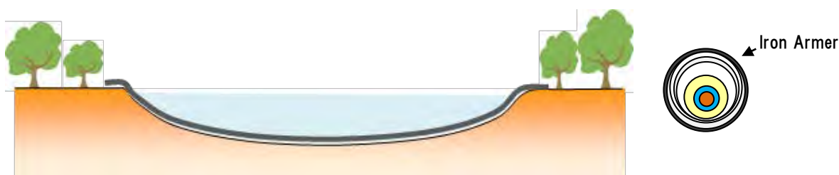
図 5.17 超電導直流ケーブルの河川横断の模式図
