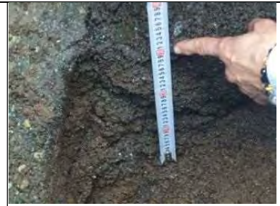
写真-18 アンスラサイトとろ過砂の混合状況
