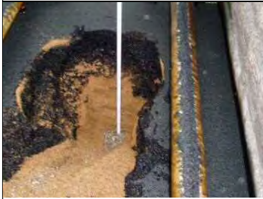
写真-19 福岡市における案さ裏サイトとろ過砂の二層状況
