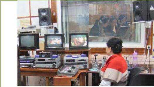
写真-3：編集スタジオの作業風景。映画の吹き替えを行っている。現在はDV CAMのリニア編集機材を使用しているが、来年からはXDCAMに移行する予定。
