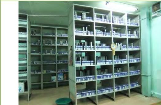
写真-7：MNB-TVが管理するテープ保管室。エアコン、空調器が整備され、専門スタッフが常駐し、温度は15～20度、湿度は40～60%に保たれている。
