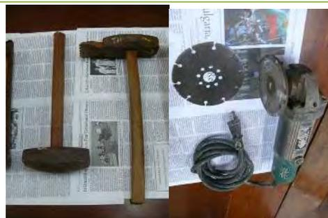
写真-8: 石材の加工に使用する工具セット。以前に実施された上智大学による西参道北側東部の修復で使用された。すでに老朽化が進み、現在は使用していない。
