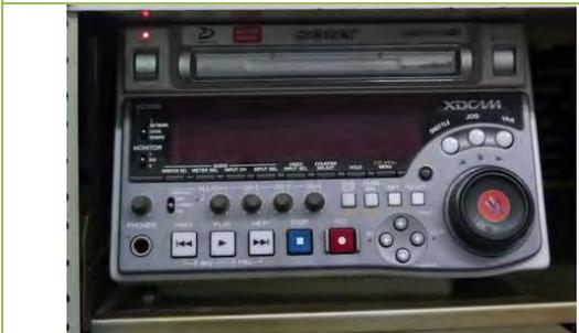
写真-5：中央制御室に設置されたXDCAM HDレコーダー。本案件により整備された番組はこの機材で再生される。
