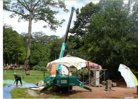
写真-6: JSA のサイトで使用されている小型クローラークレーン。小回りが利き足場が不安定な場所でも使用できることから多くのサイトで使われている。
