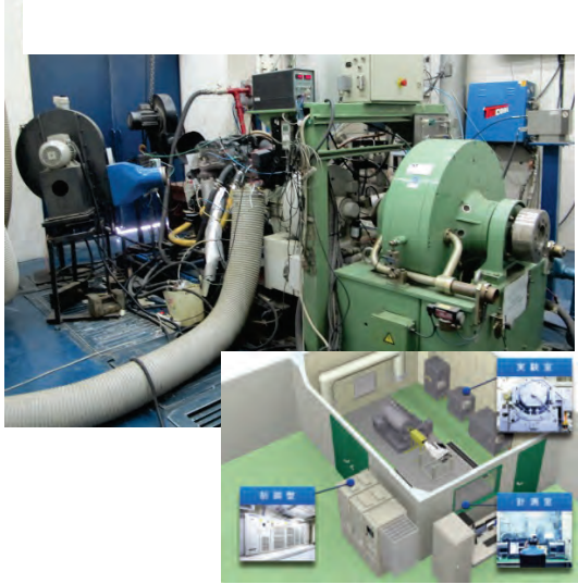
سیستم انجین داینامومتر برای خودروهای دیزلی
