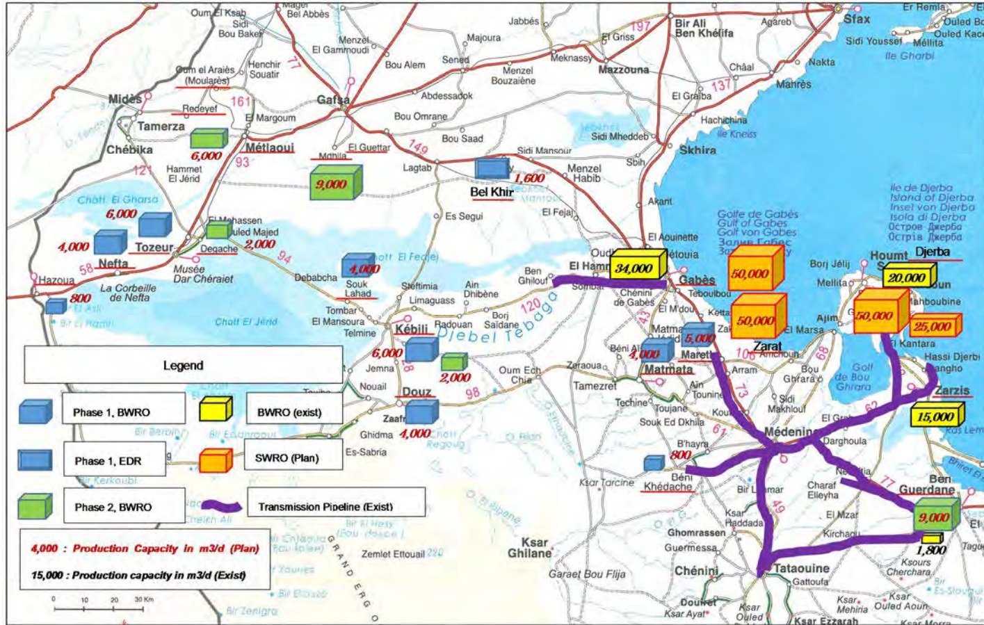
図 3-19 南部地域淡水化設置場所ならびに送水管網
