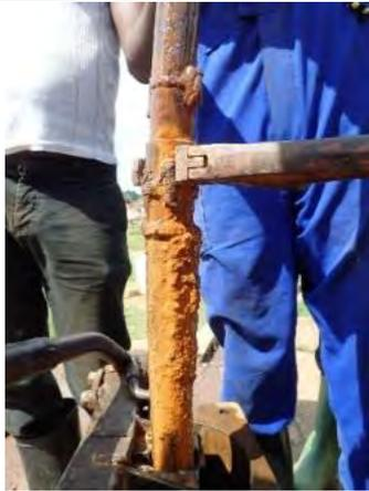
写真-3 : 既存井戸は維持管理状況が悪く、井戸内部のポンプシリンダーが錆びで劣化している。
