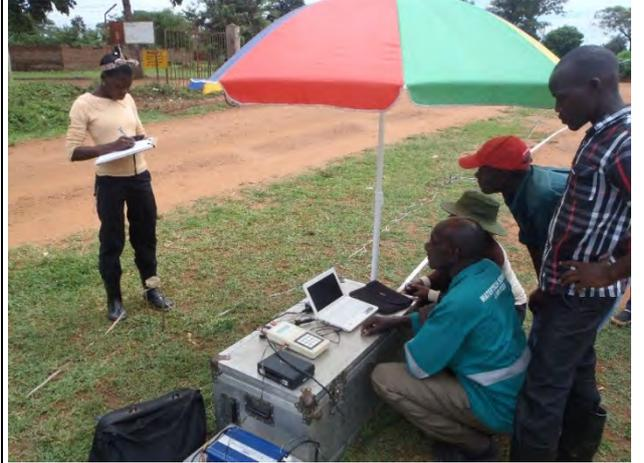
写真-10 : 物理探査 (2次元電気探査) の測定状況。
