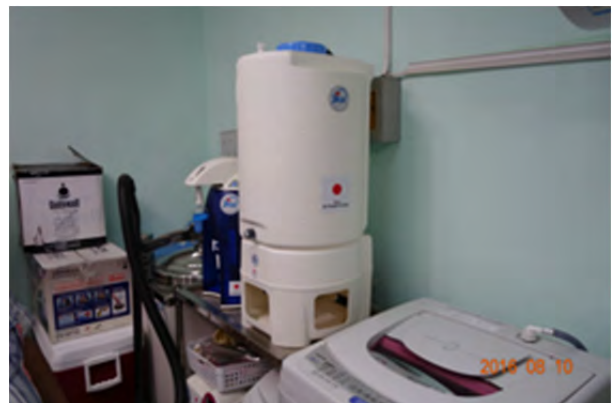
供与機材 (超純水製造装置)
