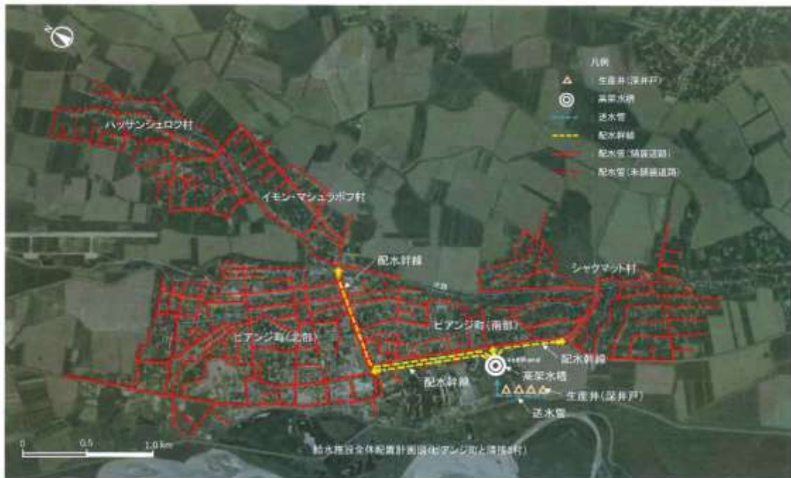
図 4-1-3 ピアンジ町と隣村 3 村の給水施設全体配置計画図
