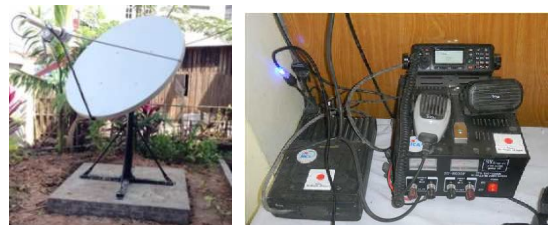
写真2 衛星通信(左)、シングルサイドバンド無線 SSB(右)
