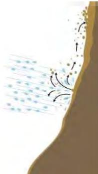
FIGURE 8 MÉCANISME DE L'ÉROSION HYDRIQUE
