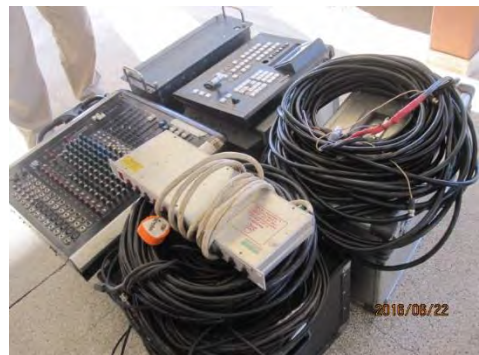
写真-16: 外部持ち出し機材。スタジオ等にて使用している機材を毎回取り外して持つため老化が激しい。
