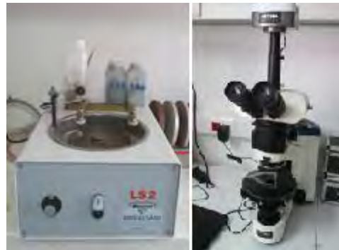
写真-8:EUより供与の既存機材(左:試料研磨機、右:光学顕微鏡)
