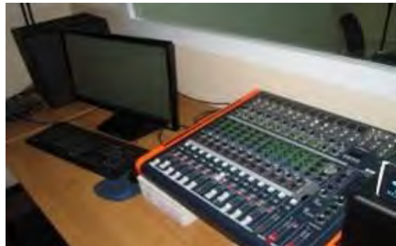
写真-6：録音編集室。隣室のマイクでナレーションや音楽を録音したものを編集する
