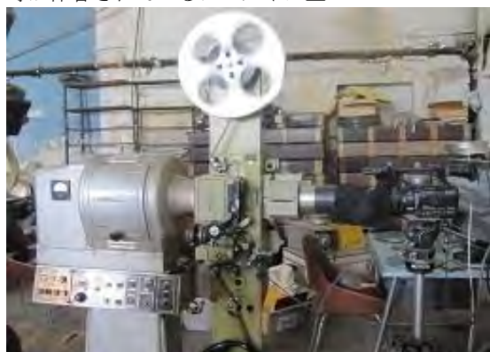
写真-6：1979 年製の 35mm フィルムスキャナーの映像をビデオカメラ経由で撮影
