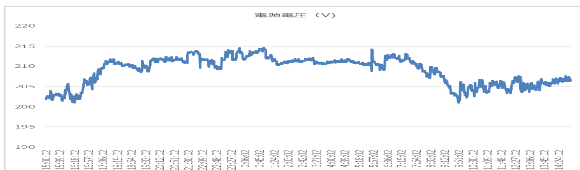
図 3-2 OHCH における電源電圧（220V）変動状況（測定日時：2014 年 9 月 10 日～9 月 11 日）
