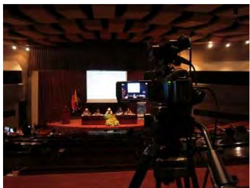
写真-5：講堂のCIESPALが自助努力で購入した汎用HDカメラ。リモコン機能がないため操作要員が必要。
