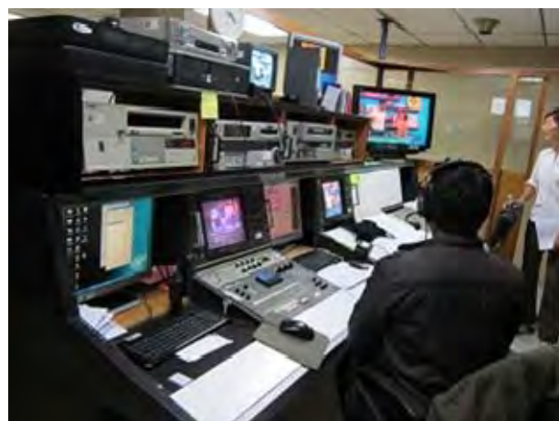
写真 2： 主調整室 放送番組を監視するとともに、番組表に沿って自動または手動で番組の切り替え操作を行う。
