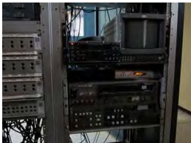
写真 3： 主調整室用 VTR 供与予定のテレビ番組ソフトが再生される VTR。
