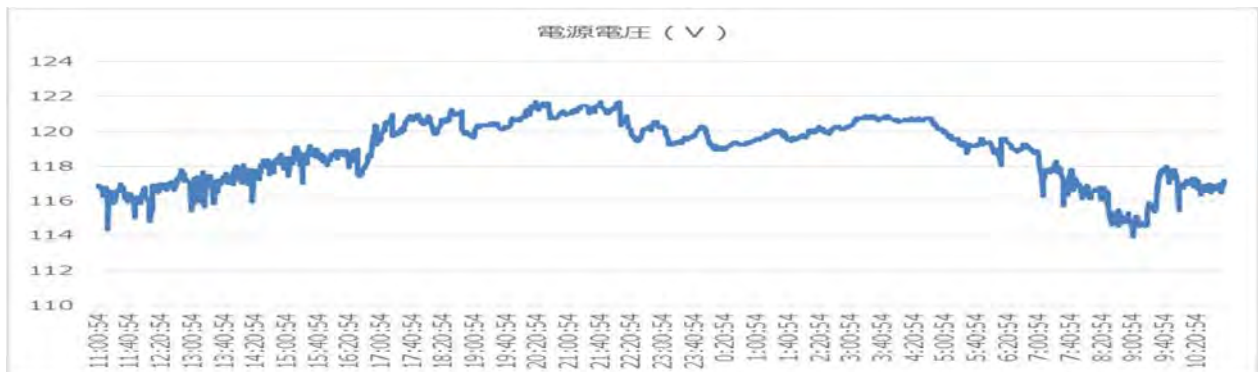
図 3-7 IOJ における電源電圧変動状況 (測定日時：2014 年 9 月 23 日~9 月 24 日)
