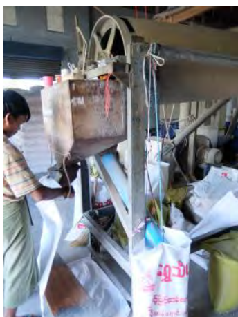
精米の最終工程（破碎米の除去）
