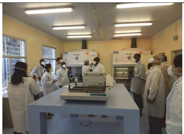
P3 検査室の内観。約 40 m<sup>2</sup>。中央の造り付け固定検査台の周囲に安全キャビネット等の検査機材が設置されている。天井はクロマイト鋼製パネル仕様。
