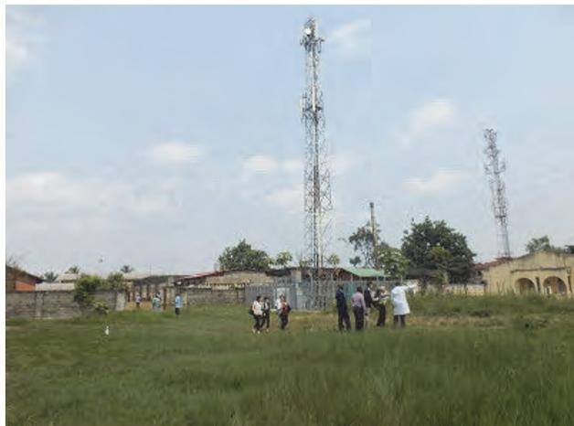
写真1 本件建設用地。敷地は平坦であるが既存家屋等の撤去移設を要する。地中障害物も発見されなかった。奥に見えるアンテナは移設対象外である。
