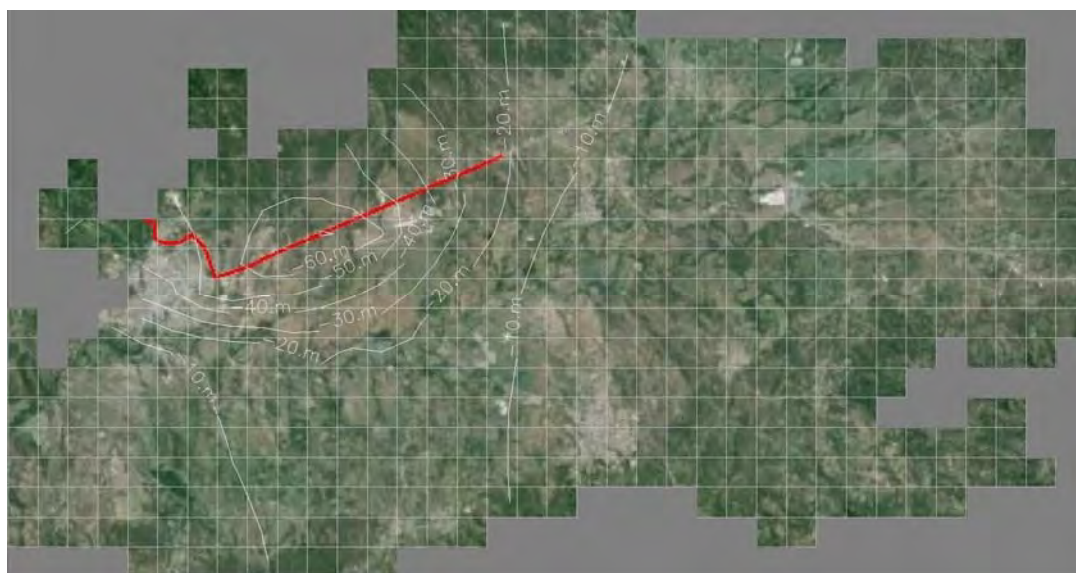
Figura 8 Distribución del descenso del nivel freático de aguas subterráneas por el desarrollo de aguas subterráneas (m)
