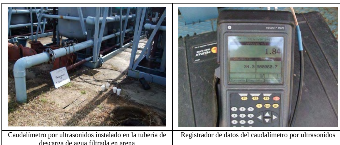
Fotografía 4 Imagen de la medición de la capacidad de potabilización (Fuente: Equipo de Estudio de JICA)
