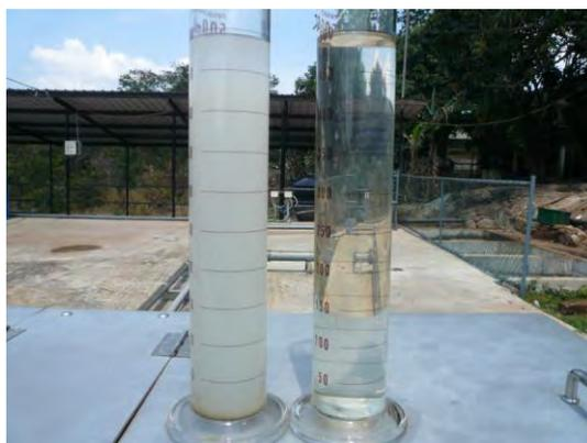
図 3-7 原水（左）と処理水（最終排水：右）の比較（2016年10月15日）
