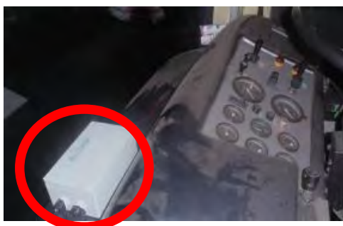
図 2.53 バスに設置されたGPS装置
