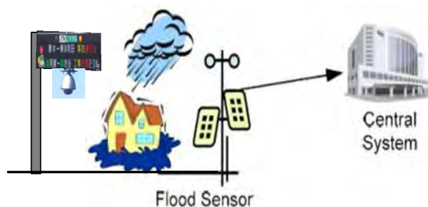
図 6. 12 冠水計測・警告システムイメージ
