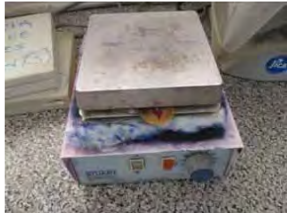
ラボ室：ホットプレート 使用頻度が多く清掃も行っていないため薬品等が付着し老朽化の原因になっている。
