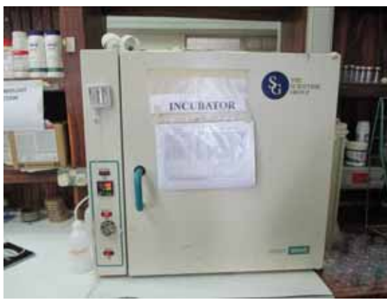
臨床検査室：インキュベーター ツマミ部分をテープで固定し使用している。
