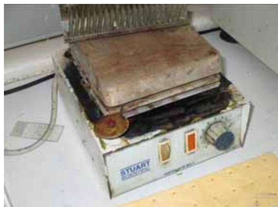
ラボ室：ホットプレート 使用頻度が多く清掃も行っていないため薬品や血液が付着したままで老朽化している。
