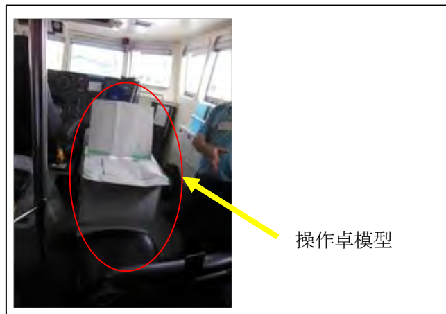
図 21 操作卓設置場所の調査
