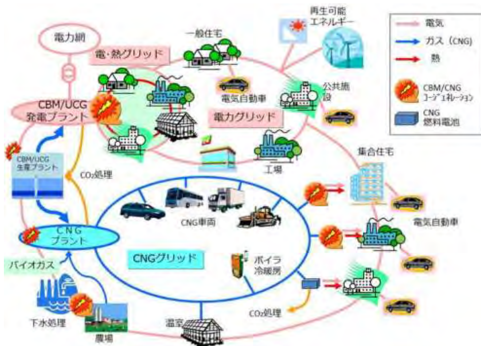
図 5.3.5 CBM/UCG ローカルエネルギー供給システム概念図
