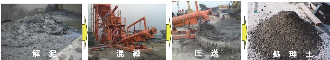
図 2-2 掘削泥土再利用システムの流れ
