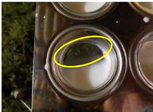
写真3-21 アルコール検査 4 : 搾乳バケツから直接採取したサンプル。凝固反応が見られる。
