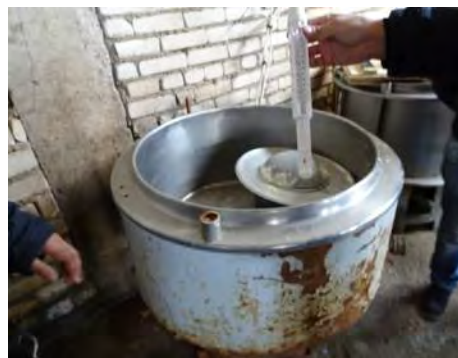
写真 5-4 殺菌タンクと温度計
