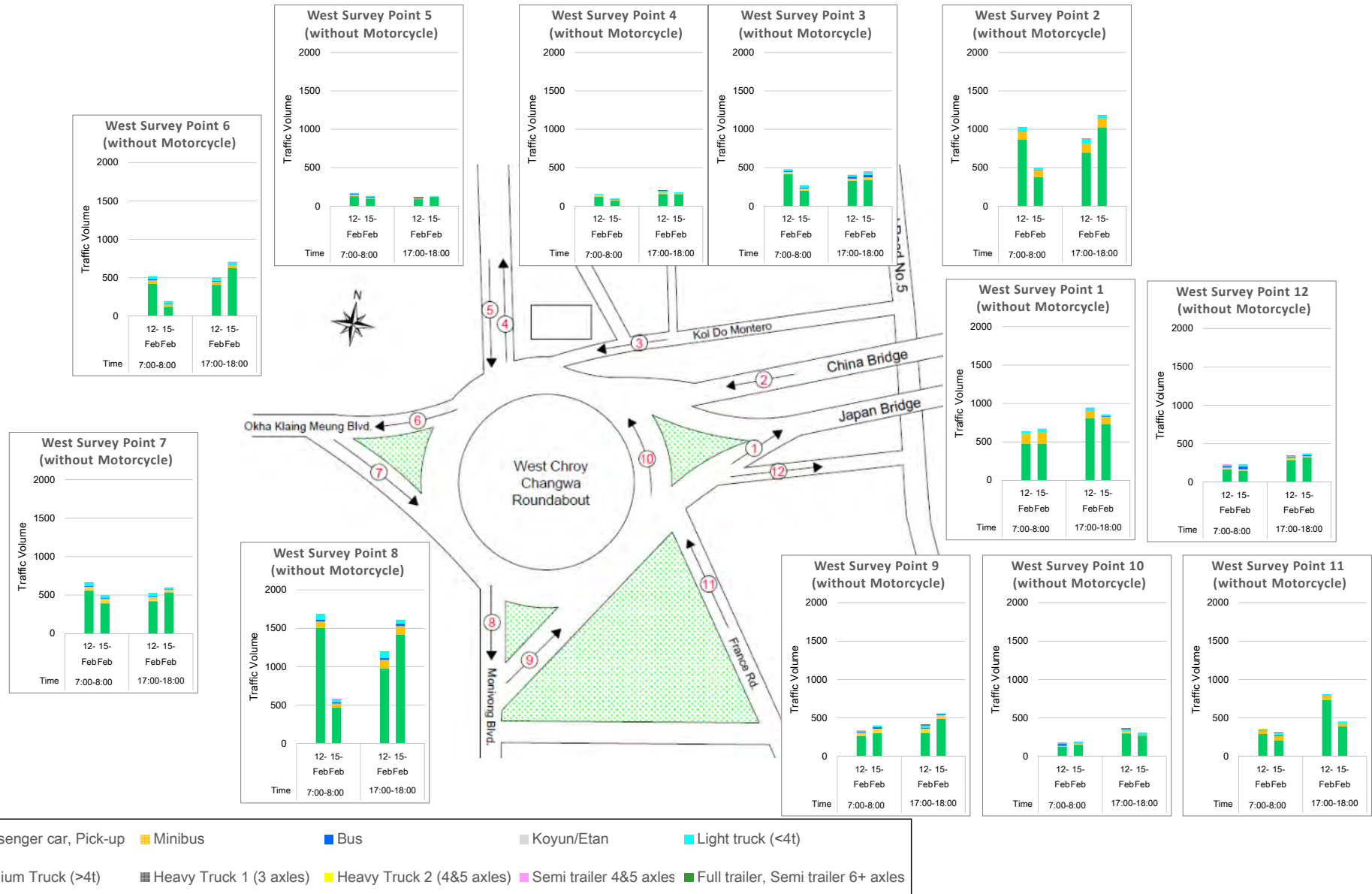
図 3-2-56 ラウンドアバウト流出入部の交通量 (台/ピーク時間) (除くバイク)
