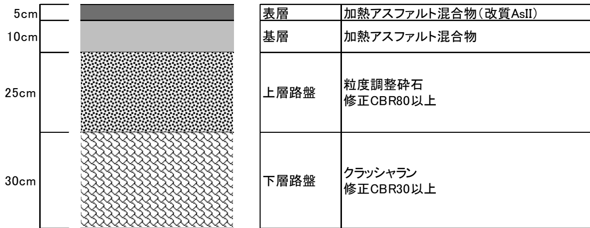
図 3-2-51 取付道路舗装構成図 (ケース 1)
