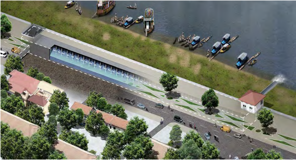
地下貯留槽（透視図）、及び排水機場
