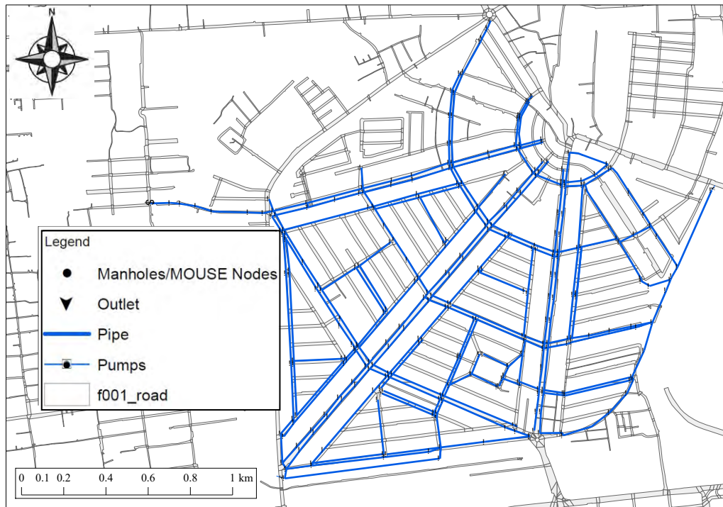
図 R 3.2.5 モデル化した管路網（トルコーク地域）
