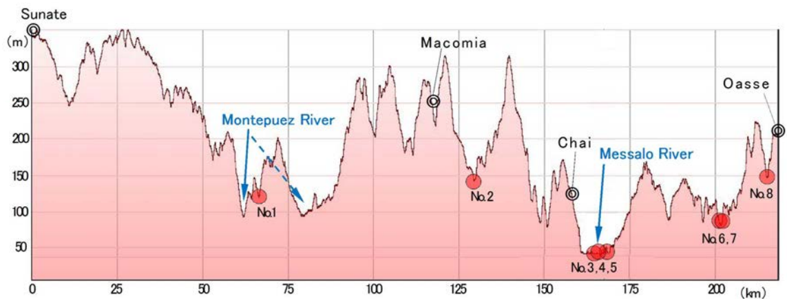
図 2-2-3 国道 380 号線の概略縦断図
