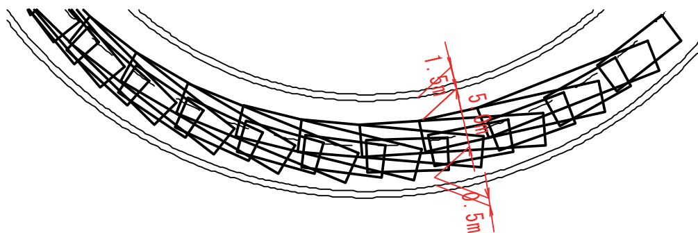
図 6.4.7 SH54IC のセミトレーラ走行軌跡
