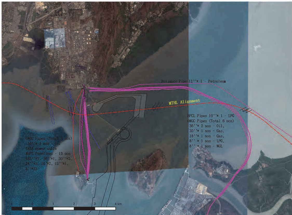
図 5.4.1 海底パイプラインとケーブル位置図
