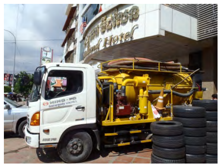
腐敗槽汚泥を引抜くバキューム車
