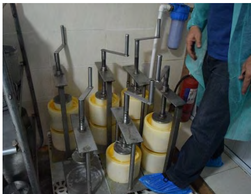
写真13 チーズプレス器でホエーを搾っている
