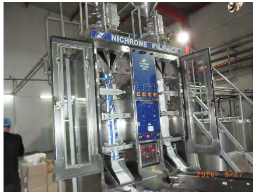
写真6 プラスチック袋入り牛乳の製造機。 フィルムを筒状にし、牛乳を充填して 個別に切断する
