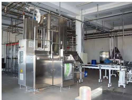
写真12 アセプティック牛乳の充填機
