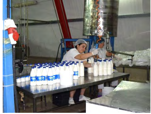
写真9 ケフィアの製造。ボトルのキャップは作業員が手で行っていた
