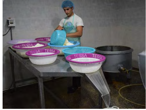
写真7 プラスチックのザルでさらにホエーを排出する
