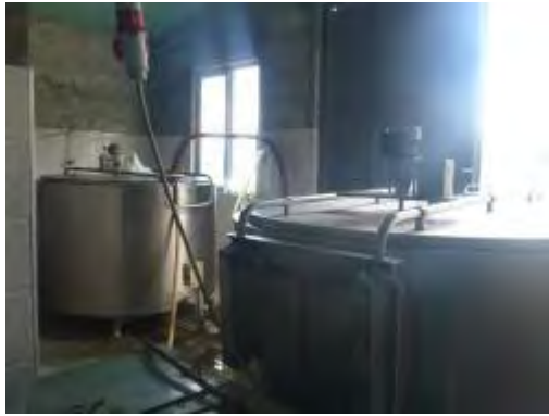
写真5 1.5tの容量があるバルククーラー
