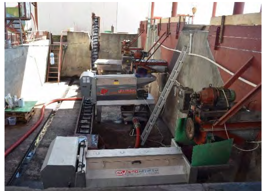
写真6 屋外にある2台のブドウ搾り機。搾った果汁は屋外にある発酵タンクに送られる
