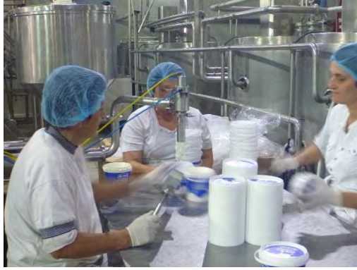
写真8 サワークリームを丸型プラスチック容器に充填し、ふたを金属棒で叩いて閉めていた
