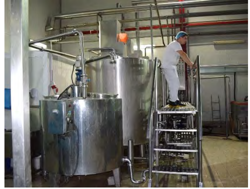
写真5 原料乳の殺菌タンク。殺菌温度は76~96℃で、製品により異なる
