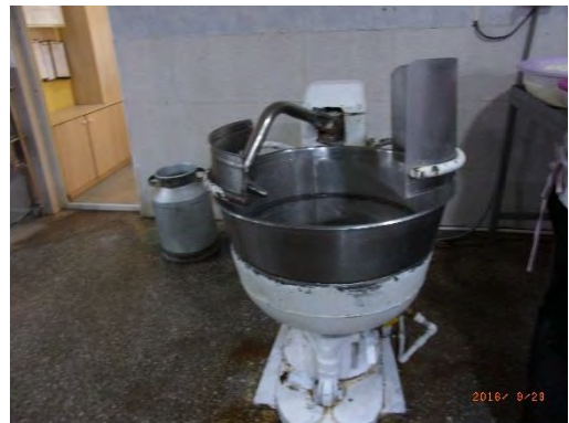
写真12 モッツアレラチーズの製造機
