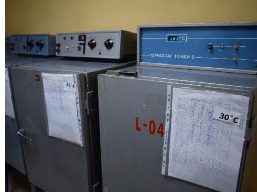
写真15 各種温度に設定された恒温器。温度管理の状態はそれぞれ記録されていた
