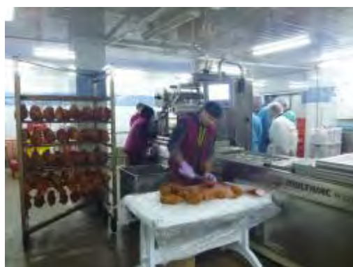
写真11 ボンレスハムをカットして 右側のラインで真空包装している
