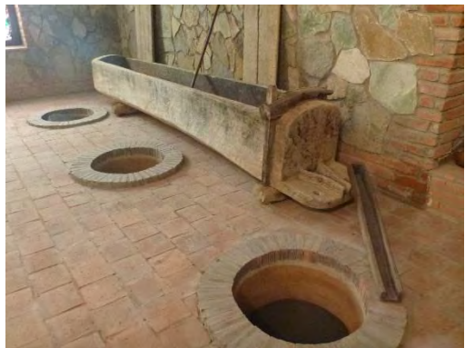
写真4 ブドウを搾る一本丸太で作った巨大なおけ
