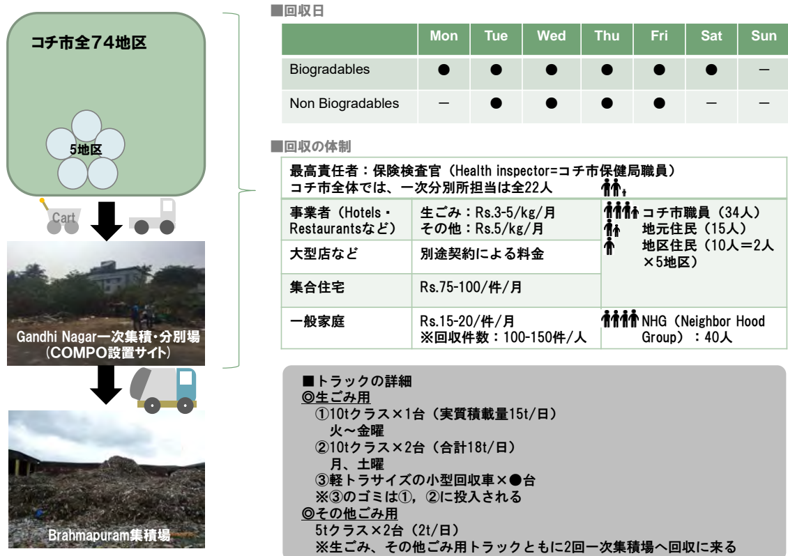
図 26 コチ市における有機性廃棄物の処理フロー
