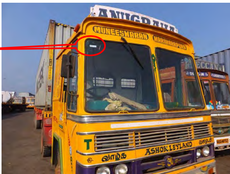
写真 3-10 トラックのフロントガラスに装着された RFID タグ
