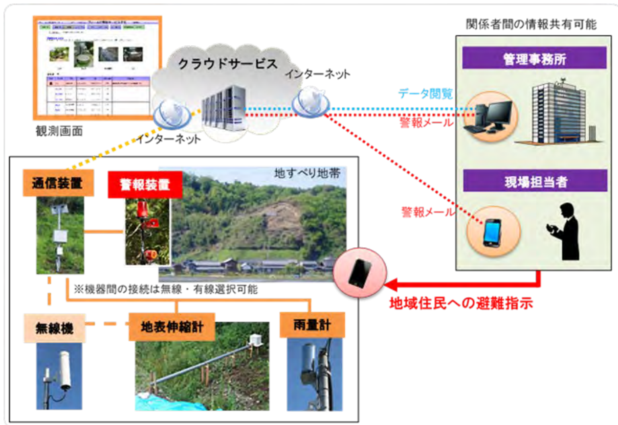
図 2-1 地すべり遠隔監視システムの概要図
