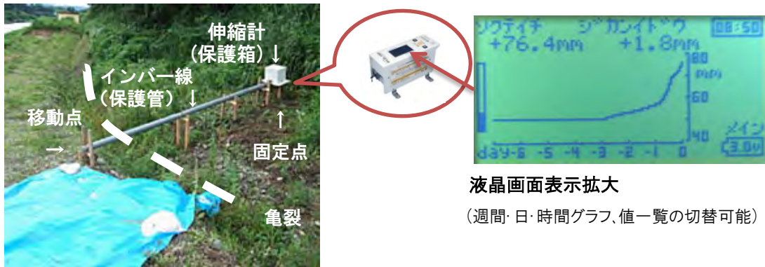
図 2-3 地表伸縮計の現場設置例と液晶画面表示 (出典：JICA 調査団作成)
