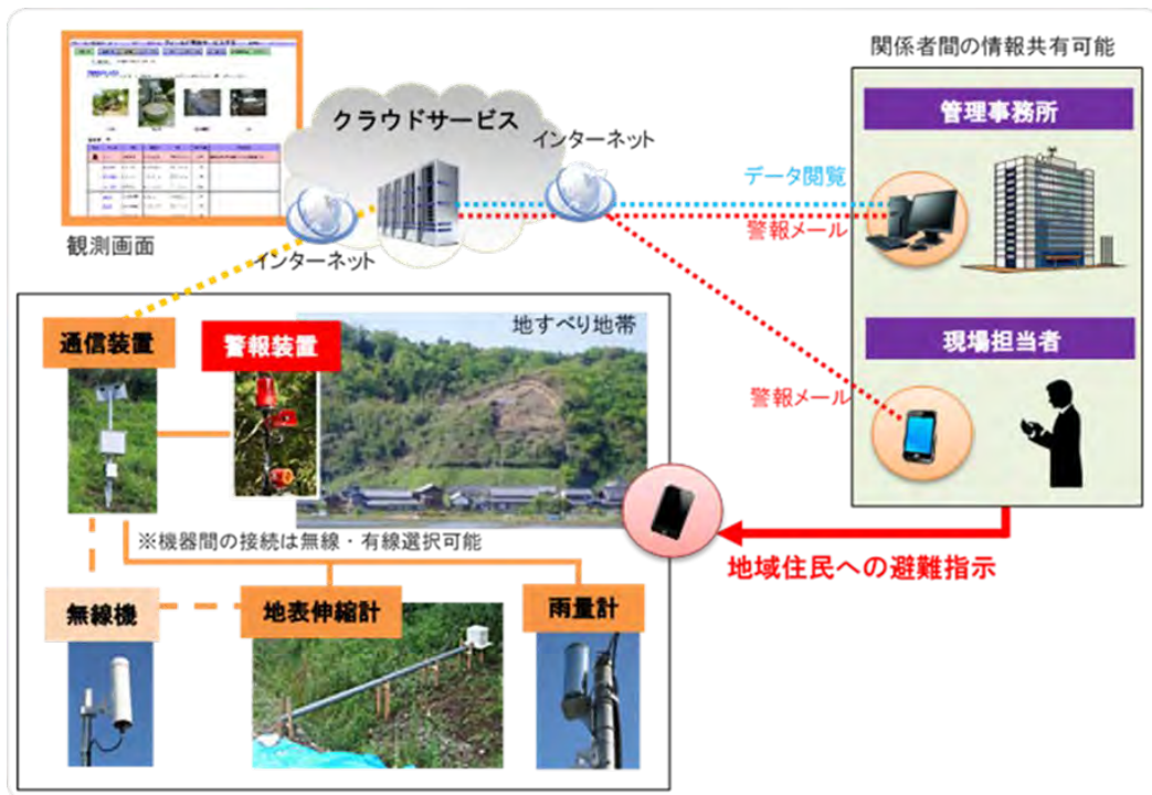
図 I 地すべり遠隔監視システムの概念図 (出典：JICA 調査団作成)
