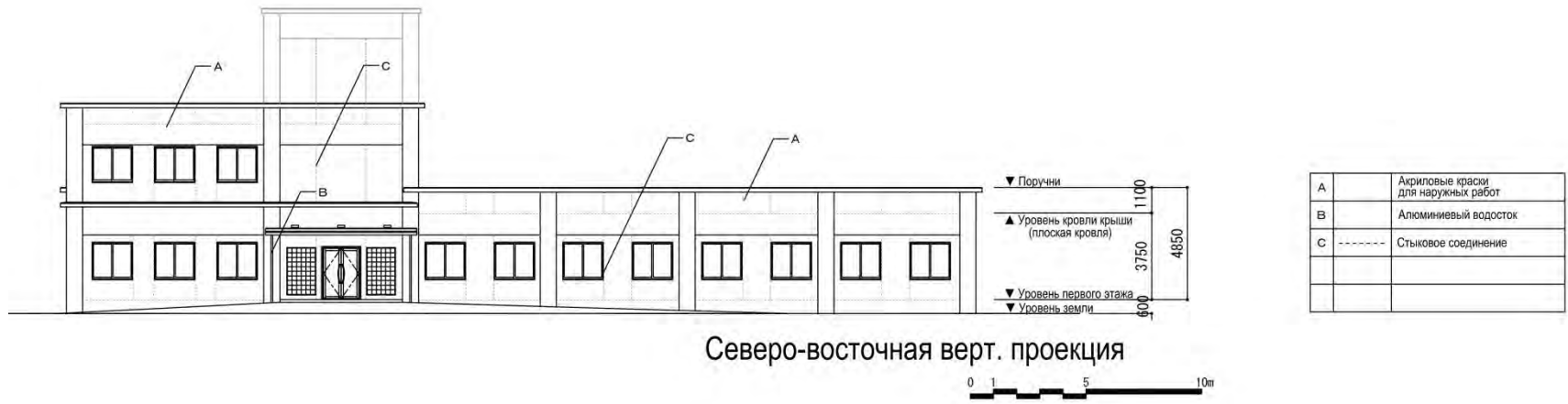
Рис. 2-15. Вертикальная проекция педатрического корпуса-1, масштаб 1/300
