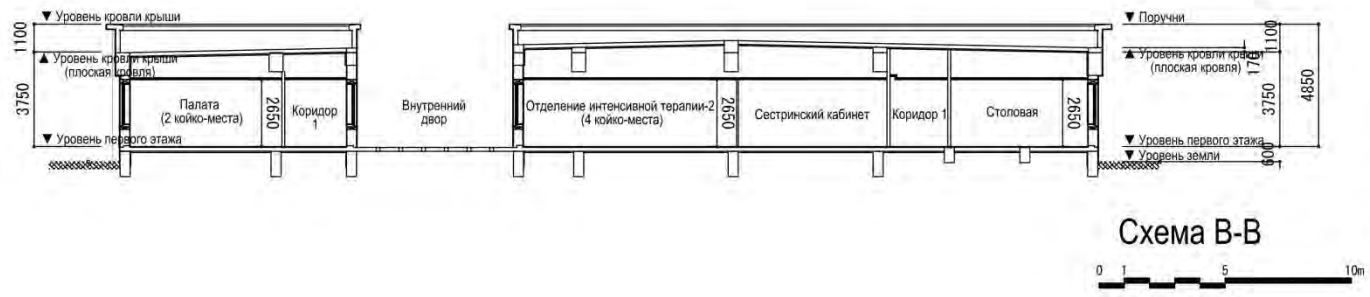
Рис. 2-17. Поперечная схема педиатрического корпуса-1, масштаб 1/300
