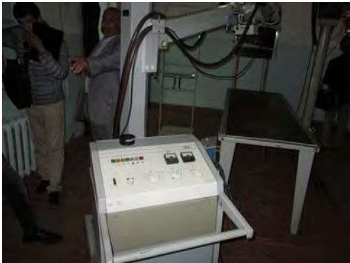
移動式X線装置(使用可能であるものの老朽化機材)
