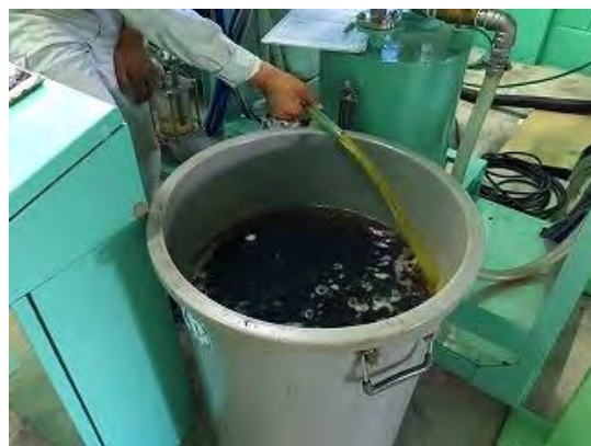
写真3：試運転・検収時に廃プラから抽出した油（2016年1月）
