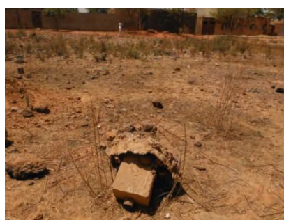
Photo 3-1 Etat des points géodésiques existants (à gauche : point normal (D0050), à droite : point endommagé (T58))
