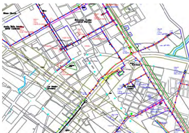
図.8 EEPC から入手した低圧送電線網図(Mojo市街地)
