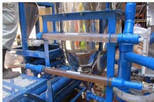
配管下段が原水、上段が処理水 (フロック状)
