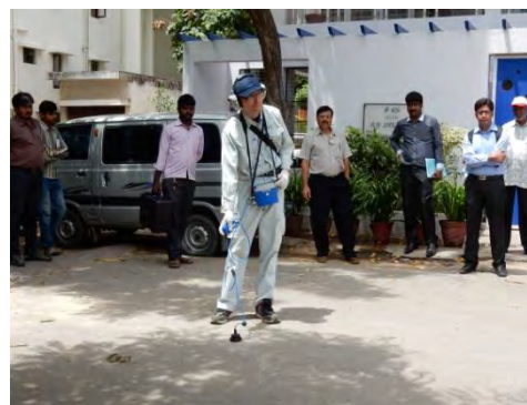
漏水探知器音聴調査
