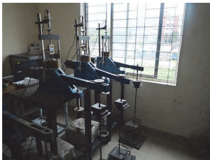
図 2-4 圧密試験状況
