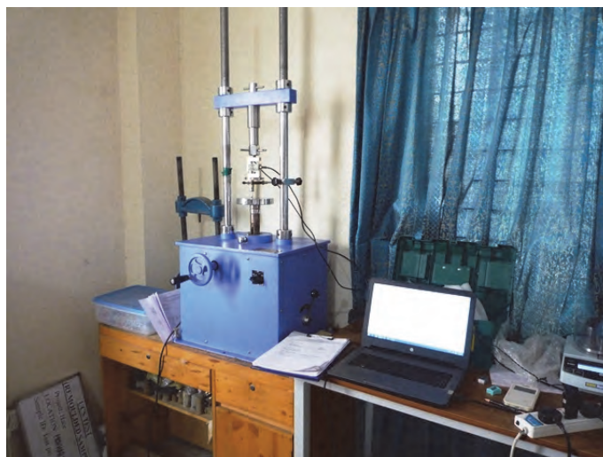
図 2-4 圧密試験状況
