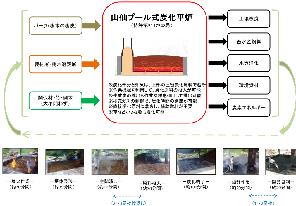
図 6 山仙プール式炭化平炉の概要
